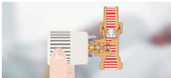
Slika 2. Kod ručnog radijatorskog ventila protok je reguliran ručnim okretanjem kola
