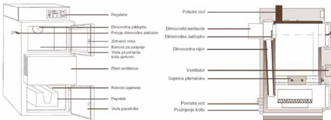
Slika 1. Vanjski izgled i presjek kotla na pirolizu
