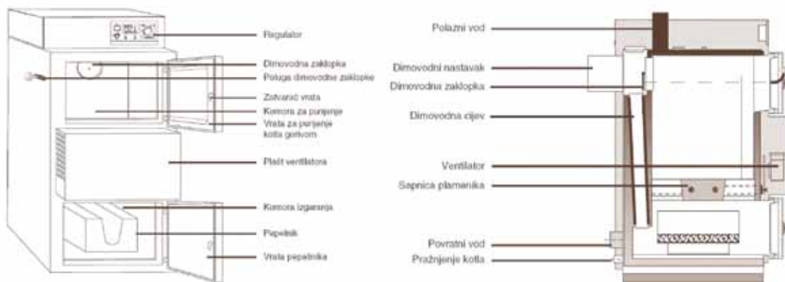
Slika 1. Vanjski izgled i presjek kotla na pirolizu
